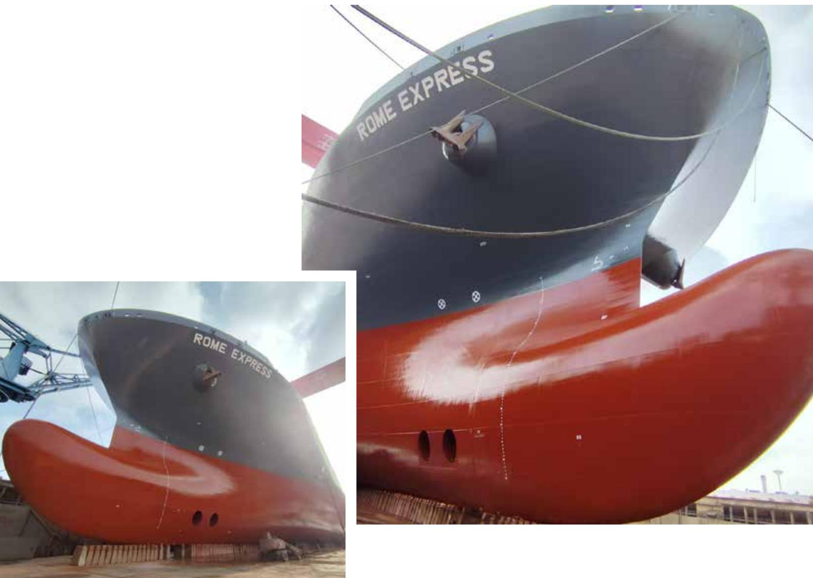
**Die ROME EXPRESS optimiert für nachhaltige Effizienz – Silikonbeschichtungen reduzieren Bewuchs, senken den Treibstoffverbrauch und verringern CO<sub>2</sub>-Emissionen. Neue, strömungsoptimierte Propeller minimieren Verwirbelungen, reduzieren den Widerstand und steigern den Wirkungsgrad, wodurch ebenfalls der Energieverbrauch sowie der CO<sub>2</sub>-Ausstoß gesenkt werden – wichtige Faktoren einer konsistenten Dekarbonisierungsstrategie.**
